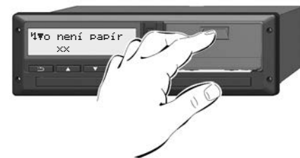
Obr. 127: Stiskněte tlačítko pro otevření
