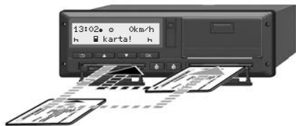
Obr. 35: Výměna karty řidiče
