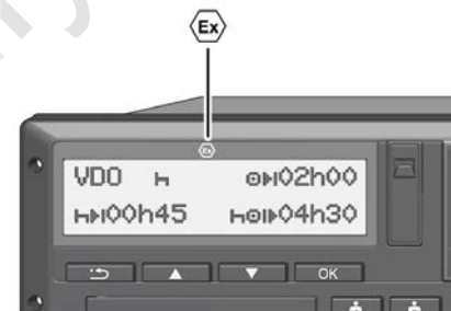
Rys. 3: Symbol Ex na przednim panelu
