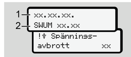
Avb. 129: Visning - Spänningsavbrott
